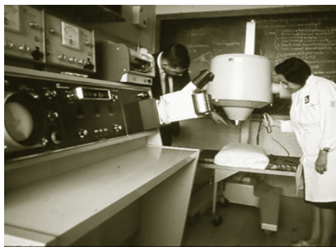
Foto 19. Gammacámara Nuclear Chicago, en la que se aprecia la pantalla circular, la pantalla con cámara polaroid y el detector con columna.
