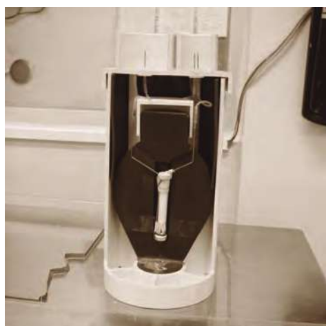
Foto 8. Generador Molibdeno-Tecnecio abierto para mostrar sus componentes.
